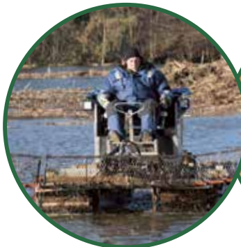
Schilfschnitt mit Mähboot "Truxor"
