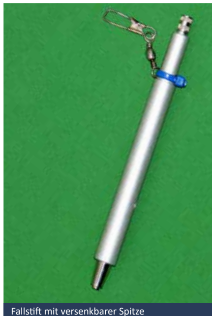
Fallstift mit versenkbarer Spitze
